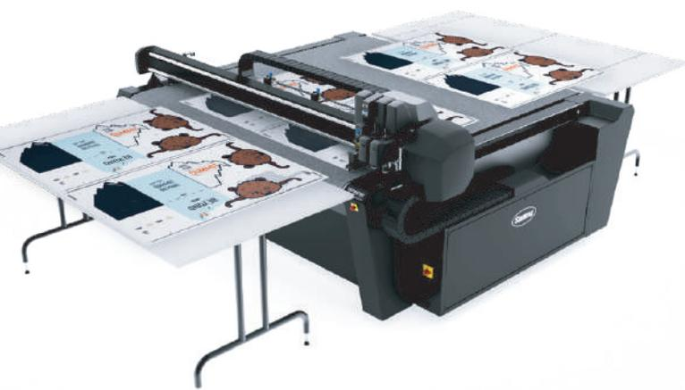
Summa F1612 также можно настроить для работы без остановки с помощью функции непрерывной подачи листов. Для этого понадобятся два приставных стола с настраиваемой высотой. Материал кладется на первый приставной стол, режется на центральной части стола плоттера, а затем с помощью конвейера подается на второй приставной стол. Пока плоттер работает, оператор может забрать готовое изделие и загрузить новый материал.
